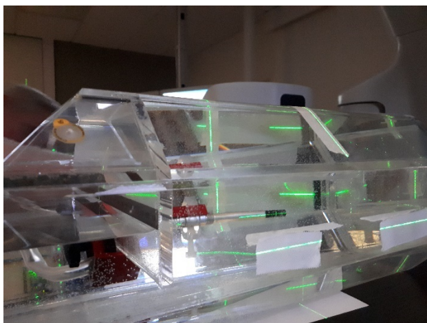
Figur 1: IVAR med Farmer-kammer under posisjonering med laser og lysfelt.
