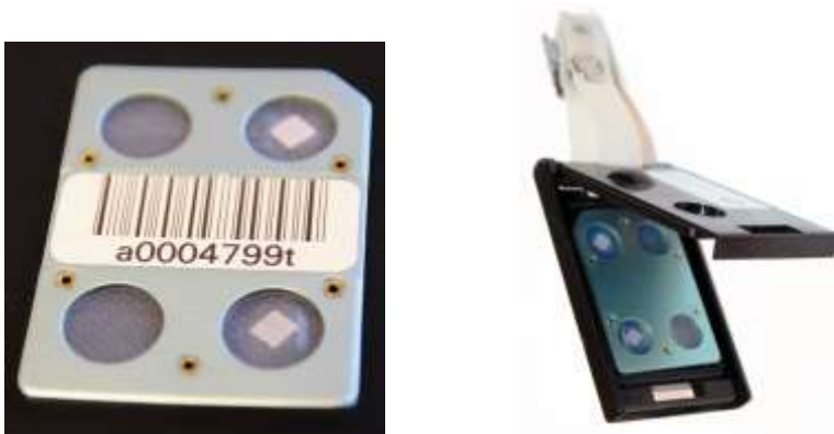
Figur 1. Bilde av dosimeterkort med to stk. TLD-elementer, og bilde av dosimeterkort i holder.
