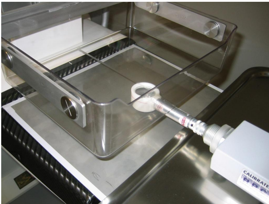
Figur 7: Oppsett for måling av stråleutbytte. For å beskytte den digitale detektoren, plasseres ei blyplate eller lignende oppå objektbordet. Merk at målingene i punkt 1-5 under metode skal gjøres uten kompresjonsplate, om mulig. (Foto: Statens strålevern)
