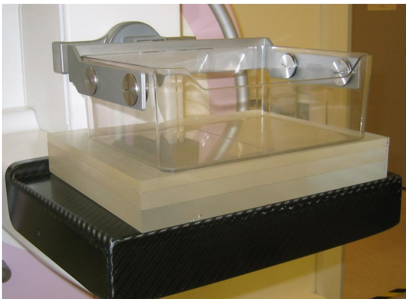
Figur 1: PMMA-plater som dekker hele detektor, her med total tykkelse 45 mm (Foto: Statens strålevern).
