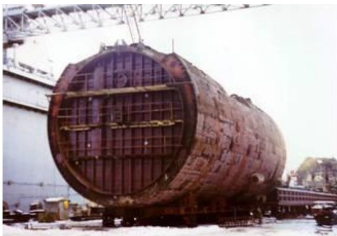
Рис.2.6.1. Трёхотсечный блок реакторного отсека утилизированной АПЛ в плавучем доке
