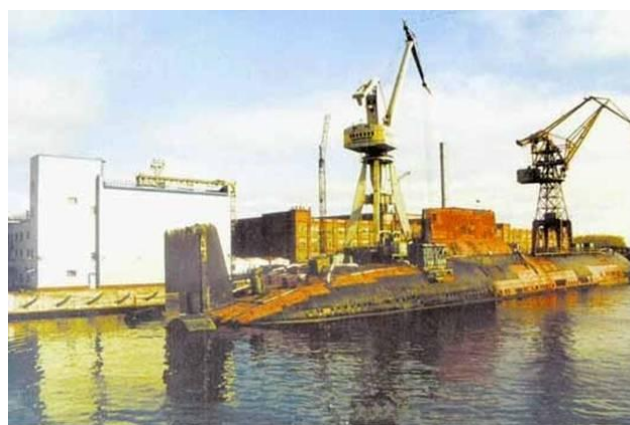
Рис. 2.1.3. АПЛ класс «Тайфун» в процессе утилизации у причальной стенки ОАО «ПО «Севмаш».
