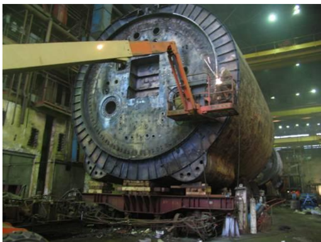
Рис. 2.6.3. Подготовка РО утилизированной АПЛ с титановым корпусом проекта 705 на стапеле эллинга СРЗ «Нерпа».
