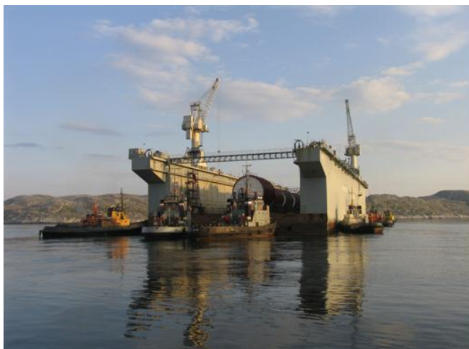
Рис. 2.6.5. Транспортирование РО в плавдоке «Паллада» с акватории СРЗ «Нерпа» в губу Сайда для передачи РО на площадку ПДХ.
