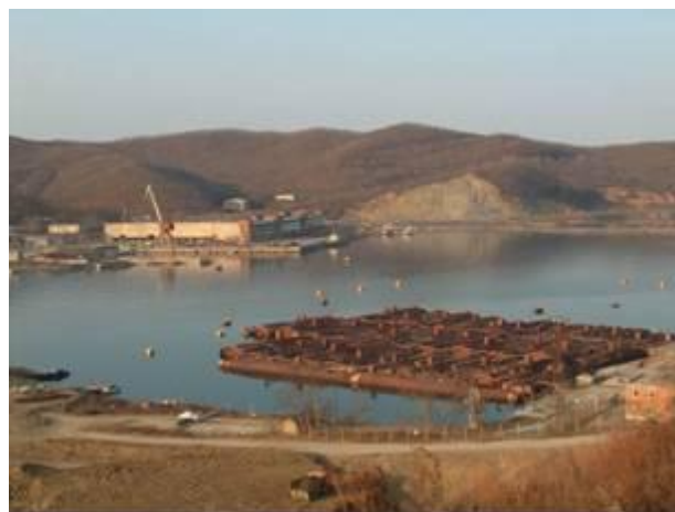
Рис. 2.6.2. Трёхотсечные блоки реакторных отсеков утилизированных АПЛ на плаву в ПВХ в бухте Разбойник
