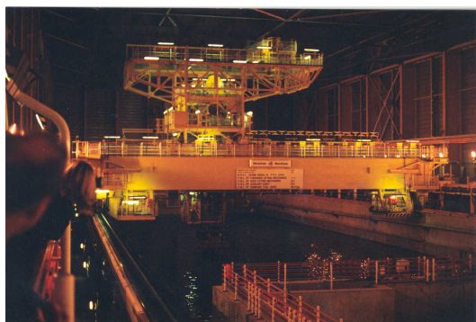
Figur 5: THORP; brukte brenselstaver kjøles ned i bassenger mens kortlivede radioaktive stoffer henfaller (foto: Statens strålevern).
