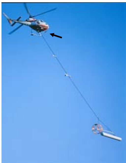
Figur 3: Et helikopter med geofysiske måleinstrumenter, inklusive et gammaspesktrometer med detektor montert på helikopterkroppen (pil).
