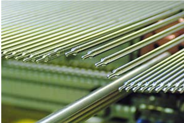
Ferdige brenselsstaver i et brenselsproduksjonsanlegg. Foto: D. Calma/IAEA
