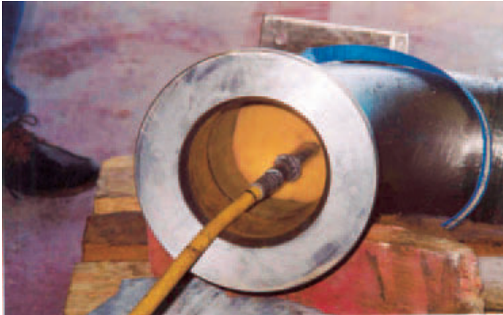
Figur 9. Industriell radiografi ved kontroll av sveiser i rør.
