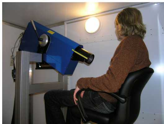
Figur 4. Utstyr for måling av cesium-137 i mennesker
