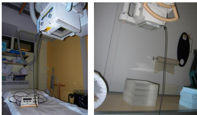
Figur 3: Kalibreringsoppsett for overbordsrør uten AEC/ABC (venstre) og med AEC/ABC (høyre). Foto: Per Otto Hetland, Statens strålevern
