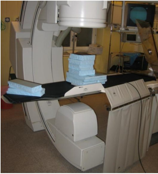
Figur 4: Venstre: Kalibreringsoppsett for underbordsrør med AEC/ABC (DAP-meteret ligger på bordet under den blå isoporen. Kobberplaten ligger oppå isoporen). Gjelder også for C-bue som skal brukes som et vanlig underbordsrør med AEC/ABC. Høyre: Kalibreringsoppsett for spesialtilfellet der C-buen skal brukes uten bordet i strålefeltet. Foto: Per Otto Hetland, Statens strålevern
