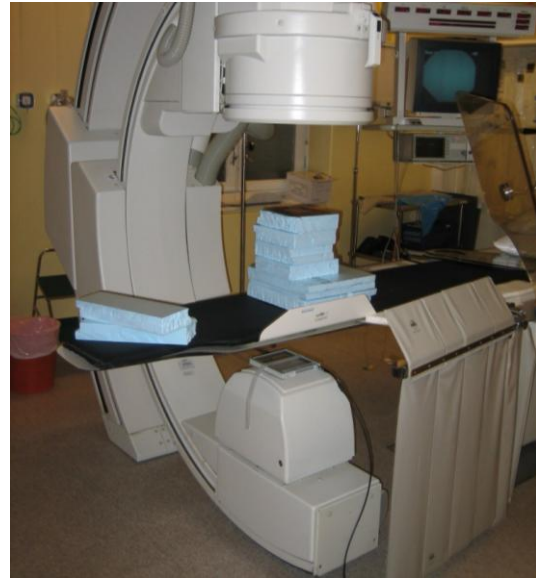
Figur 4: Venstre: Kalibreringsoppsett for underbordsrør med AEC/ABC (DAP-meteret ligger på bordet under den blå isoporen. Kobberplaten ligger oppå isoporen). Gjelder også for C-bue som skal brukes som et vanlig underbordsrør med AEC/ABC. Høyre: Kalibreringsoppsett for spesialtilfellet der C-buen skal brukes uten bordet i strålefeltet. Foto: Per Otto Hetland, Statens strålevern
