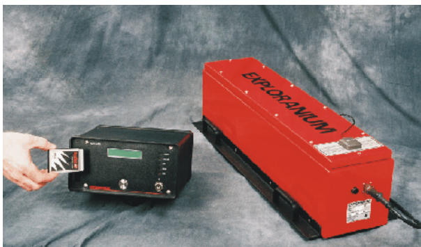
Spektrometer og tilhørende 4 liters NaI-detektor
