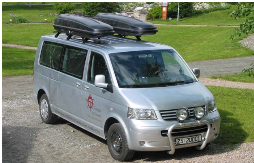
Strålevernets bil ved Beredskapsenheten påmontert utstyr for mobile målinger (Foto: Statens strålevern)
