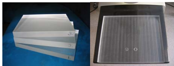
Testobjekt bestående av PMMA-plater i flere tykkelser
