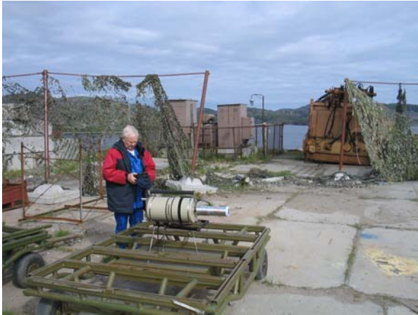
Замер спектра радиационного излучения в районе блока сухого хранения на территории объекта ПВХ филиала № 1 «СевРао» в губе Андреева
