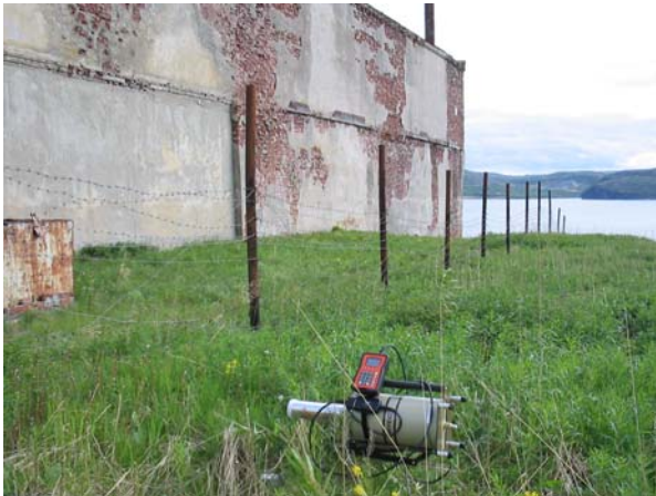
Замеры мощности дозы гамма излучения и замеры спектра радиационного излучения на территории здания № 5 филиала № 1 «СевРао» в губе Андреева
