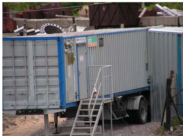
Мобильный пункт дезактивации (санитарный проход / пункт проверки) на промышленной площадке филиала № 1 «СевРао» в губе Андреева.
