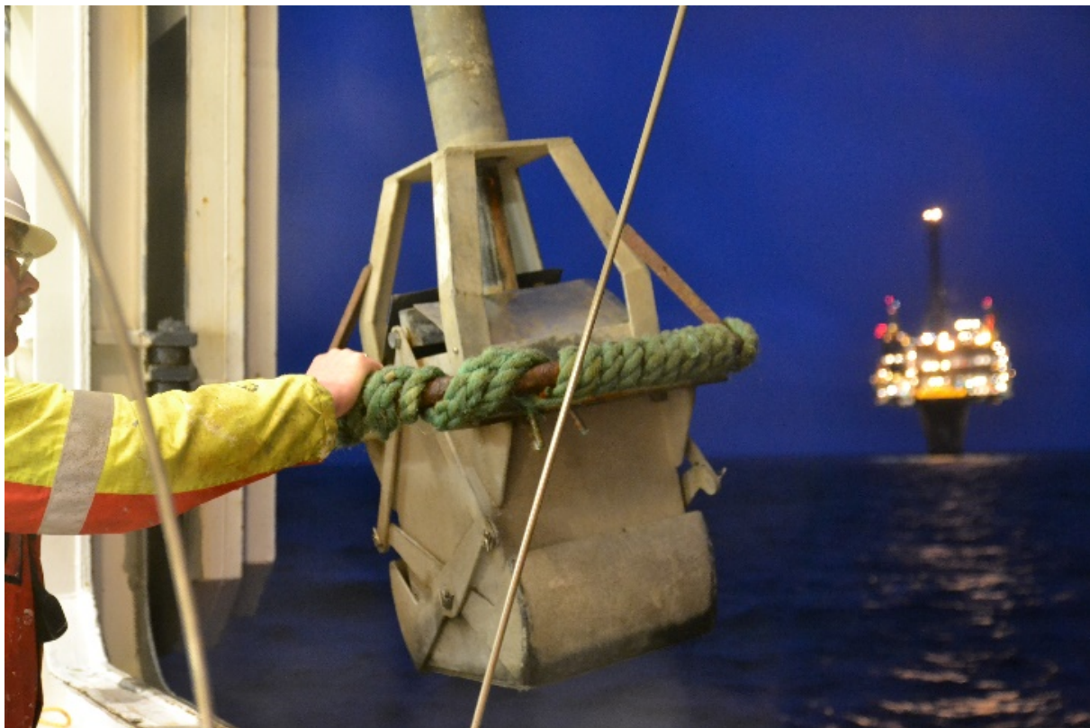
Prøvetaking av sedimenter i nærheten av oljeplattformen Draugen i Norskehavet i 2017. Foto: Hilde Elise Heldal, HI.
