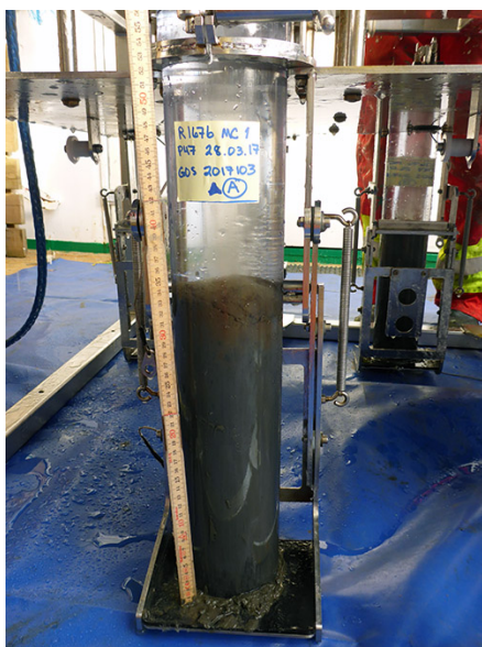
Figur 5. Sedimentkjerne tatt for MAREANO-prosjektet. En kjerneprøve tas ved å skyve et sylindrerør ned i havbunnen. Kilde: Mareano.no.
