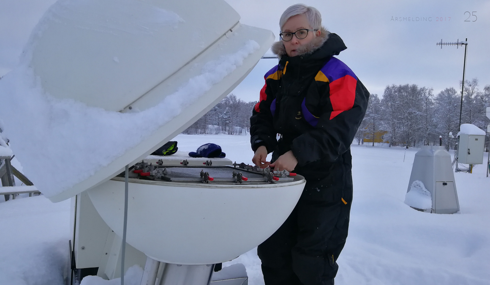
Luftfilterstasjonen på Svanhovd var ein av stasjonane som målte jod i lufta i 2017. Foto: Bredo Møller, Strålevernet.
