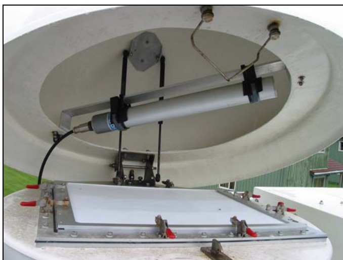
Figur 28: "Rados" - Geiger-Müller-rør overvåker doseraten i sann tid over luftfilteret i Stavanger (foto: Statens strålevern)
