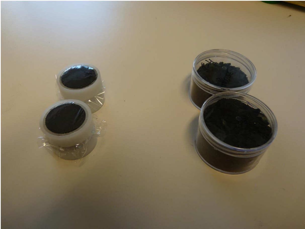
Til venstre; prøver klare til å måles med XRF, til høyre; prøver i W1 til gammaspektroskopi.
