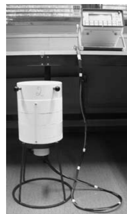
Figur 4.1. Instrumentet som LORAKON bruker til måling av radiocesium næringsmidler. Manglekanalanalysatoren på benken er tilkopleet en forforsterker og en detektor som er plassert i blytårn.
