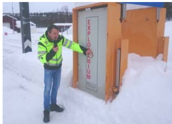
Portal for å oppdage radioaktiv materiale ved Storskog grensestasjon. Foto: Statens strålevern.
