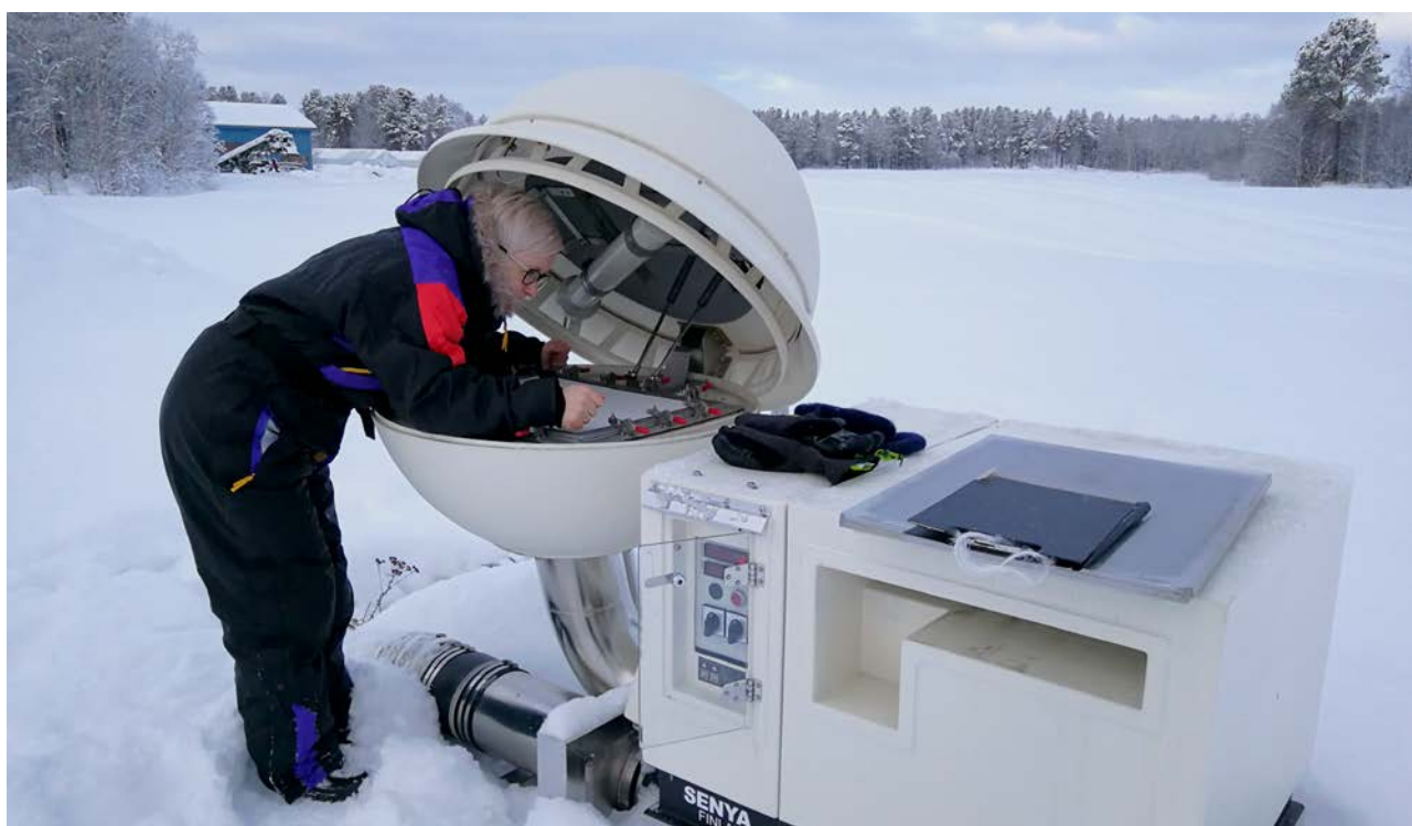
Strålevernet har seks luftfilterstasjonar for å overvake luftmassane i Noreg for radioaktivitet. Filtrane i desse stasjonane samlar opp støv frå lufta i løpet av ei veke, og vert deretter analysert ved Strålevernet sine laboratorium. På biletet ser vi stasjonen på Svanhovd i Finnmark. Foto: Bredo Møller, Statens strålevern.
