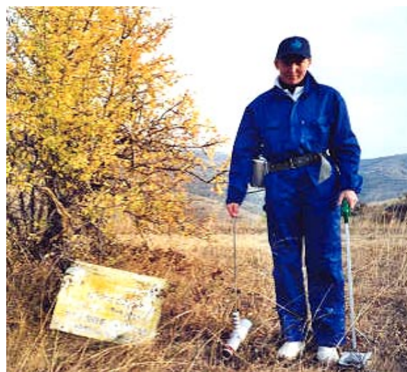
Strålevernets representant med instrumenter for måling av gamma- og betastråling.
