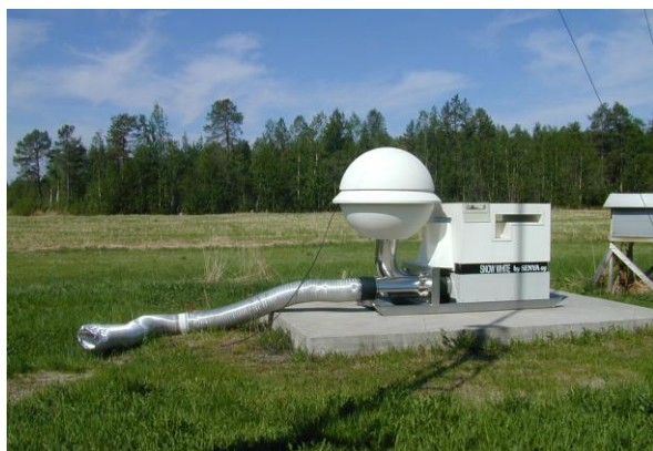
Luftsuger (Snow White) som fanger partikler fra luften i et filter som måles for innhold av radioaktivitet. (Foto: Statens strålevern)
