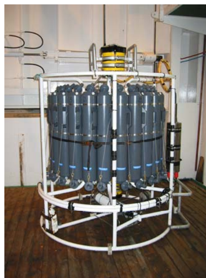
Fig. 3.4. CTD/Rosette multi-bottle sampler.
