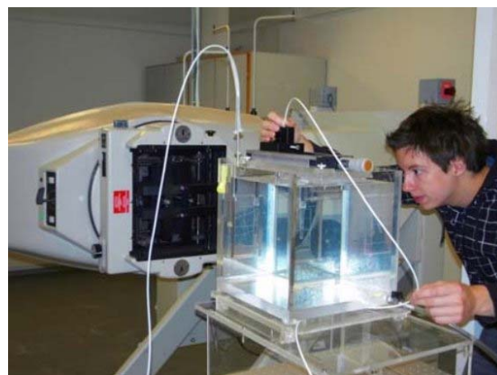
Figur 2 Måling med ionisasjonskammer i vannfantom ved dosimetrlaboratoriet på Statens Strålevern.[1]
