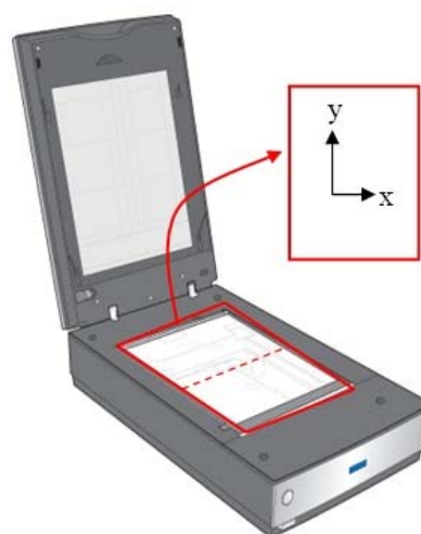
Figur 11 Skjematisk fremstilling av skanneren som ble benyttet, med markert orientering av x- og y-akser på skanneren. Figuren er adaptert fra "Epson Scan" manual [18].
