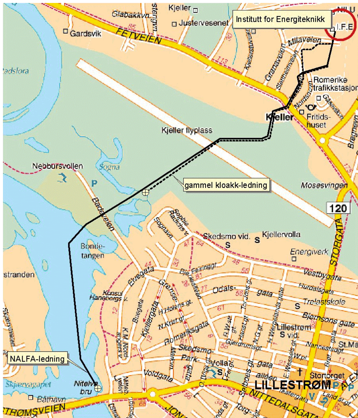
Figur 1. Oversikt over tidligere kloakkledning og nalfa-ledningens løp. Nalfa-ledningen ble tatt i bruk i 1967.
