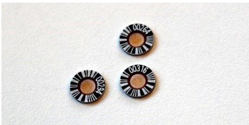
Figur C.1: Tre av dosimetrene som ble brukt i studien. Selve krystallen har en diameter på 3 mm, en tykkelse på 0,38 mm og er montert i en skive med strekkoder for gjenkjenning. Foto: Kristine Wikan
