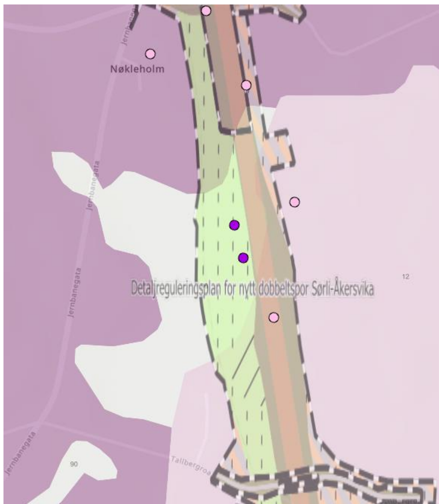
Figur 5. Kart som viser omtalt myrområde i entreprisen KSÅ-3. De to lilla prikkene markerer prøver med torv og forhøyet uraninnhold. Det hvite området er markert som myr på NGU løsmassekart. Overlagt kart er detaljreguleringsplan for dobbeltsporet.
