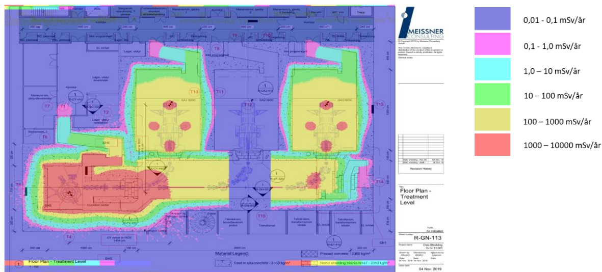
Figur 27: Oversikt over stråleintensitet ved protonterapianlegget sett ovenfra Monte Carlo-simulering
