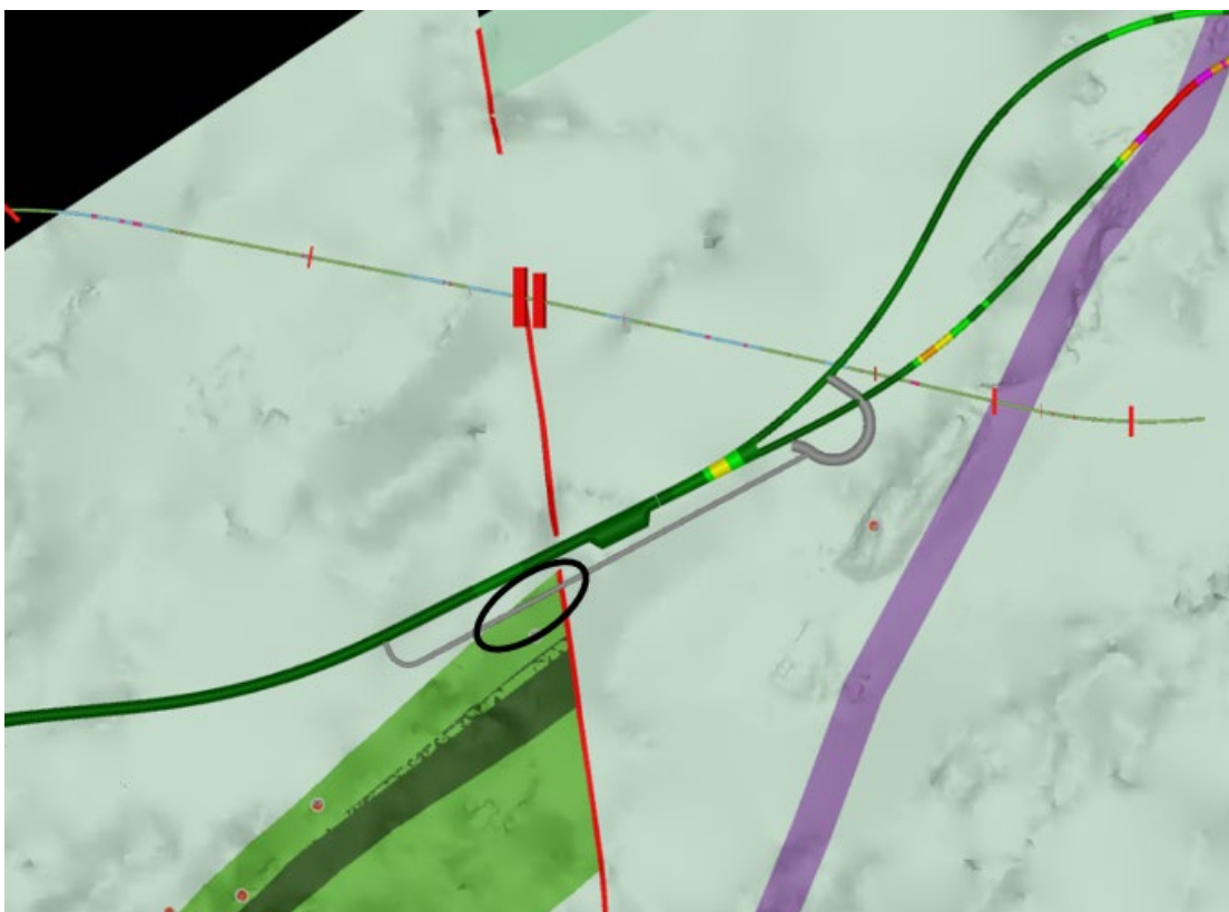
Figur 7: Svart ring viser forventet påtreff av syredannende berg i rømningstunnelen. Tverrslagstunnel og rømningstunnel på Madserud er vist med grå linjer, mens tunneltraseen er vist med grønn linje. Grønt område i figuren (både lys og mørkt) viser forventet lokalisering av alunskifer (svart og grønn skifer i lagvis veksling). Røde linjer viser kartlagte svakhetssoner.
