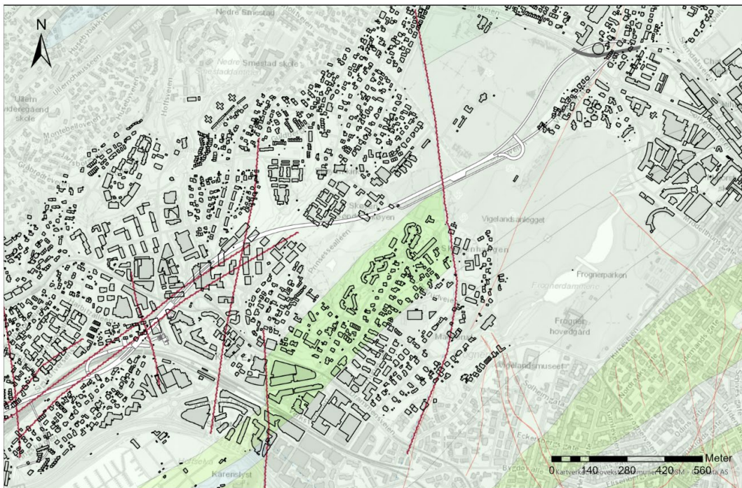
Figur 6: Forventet lokalisering av alunskifer (grønt område) og tunneltrase, samt tverrslagstunnel og rømningstunnel på Madserud. Røde linjer viser kartlagte svakhetssoner.
